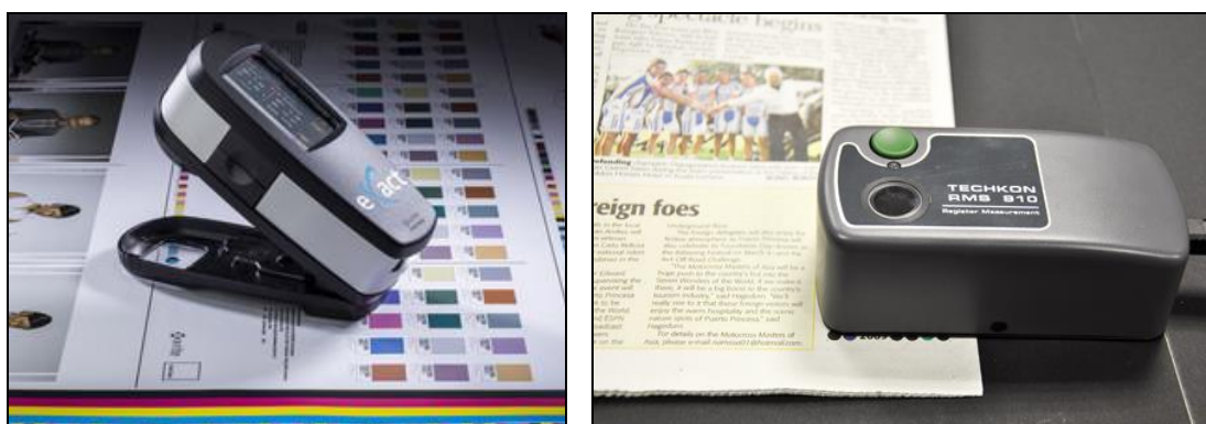
Instrumento de medición colorimétrica "eXact" de X-Rite (izda.) e instrumento de medición del registro de color "RMS 910" de Techkon (dcha.)
